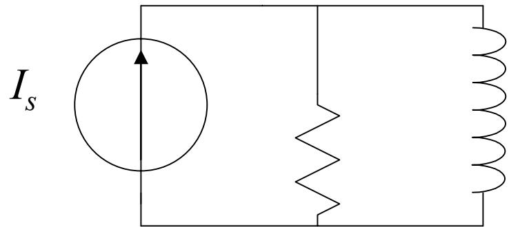
$$V_R = V_L \Rightarrow R i_R = L \frac{di_L}{dt}; \quad I_s = i_R + i_L = \frac{L}{R} \frac{di_L}{dt} + i_L$$
